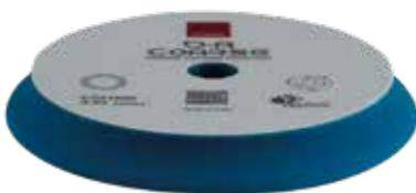
Le coussin en mousse **D-A COARSE** est le plus agressif de la gamme BigFoot. Il est spécialement conçu pour être utilisé avec des outils orbitaux et à engrenages aléatoires. La structure en mousse à cellules ouvertes unique élimine les défauts légers à graves de la plupart des systèmes de peinture lorsqu'il est associé au composé RUPES D-A COARSE.
