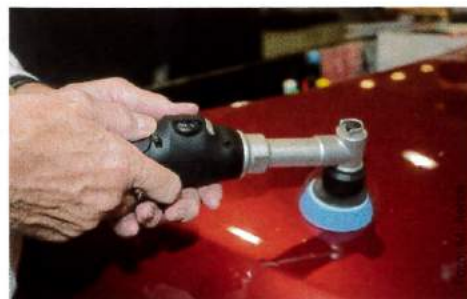
Das Gerät ermöglicht durch unterschiedliche Bewegungsarten Polieren, Schleifen und Reinigen mit nur einem kompakten, einfach zu bedienenden System.
