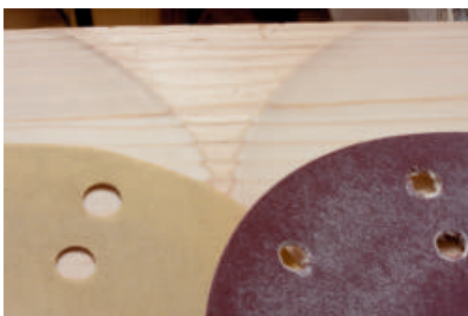
La prova della velocità di taglio su un supporto in abete verniciato. Il disco Rupes (in giallo) mangia di più e si mantiene più pulito rispetto al riferimento.
